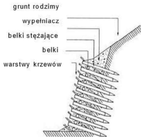
Rysunek 78. Przekrój poprzeczny kaszycy [Begemann i Schiechl 1999].
