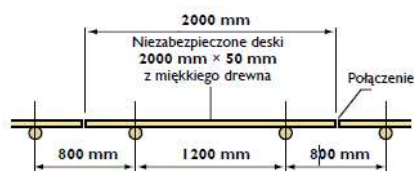
Rysunek 71. Schemat deskowania krawędzi brzozy [Krukowski 2006]
